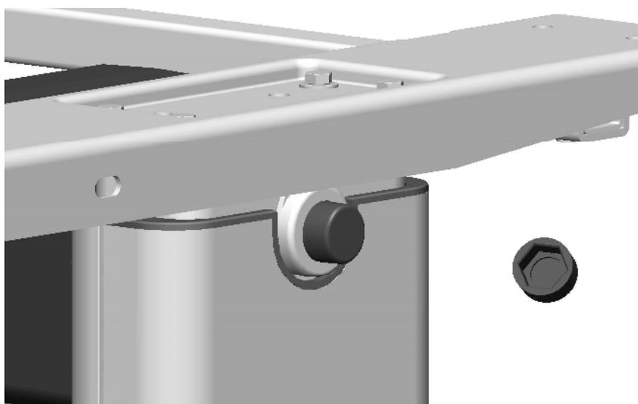
**Stecken Sie auf den Außenseiten der Beine die beiden Mutterabdeckungen über die beiden Überwurfmutter**
